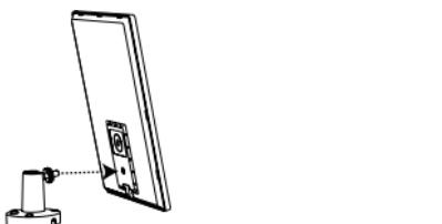
Befestigen Sie das Solarpanel an der Halterung.
