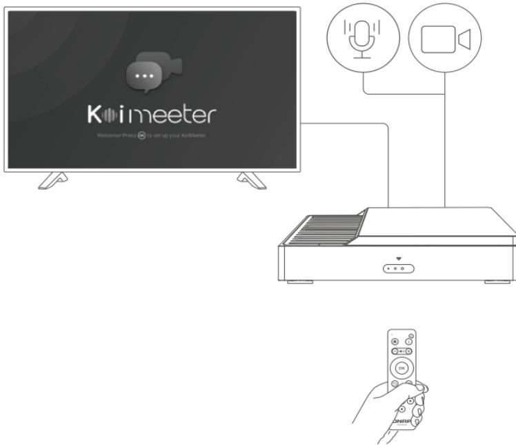
Schließen Sie die USB-Kamera und das Mikrofon an.
