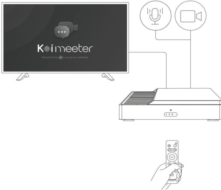
Podłącz kamerę i mikrofon USB.
