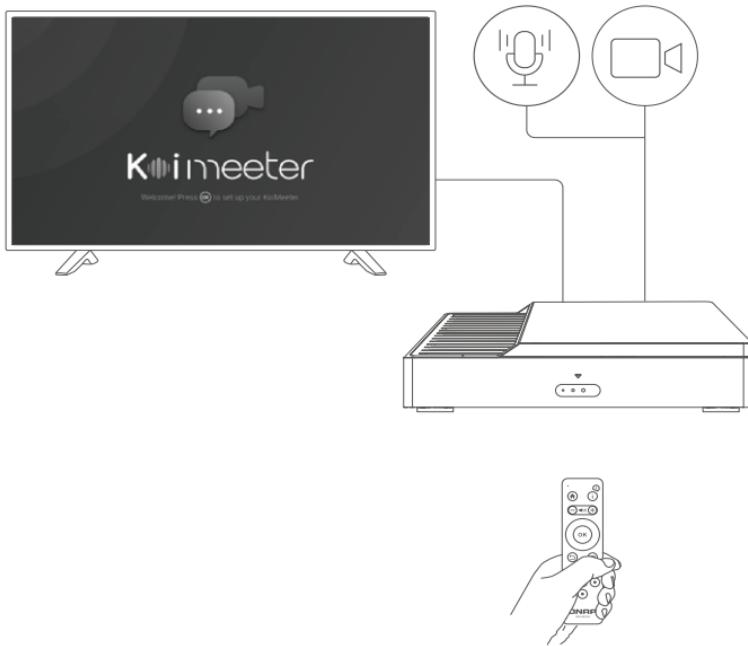
Csatlakoztassa az USB kamerát és a mikrofont.
