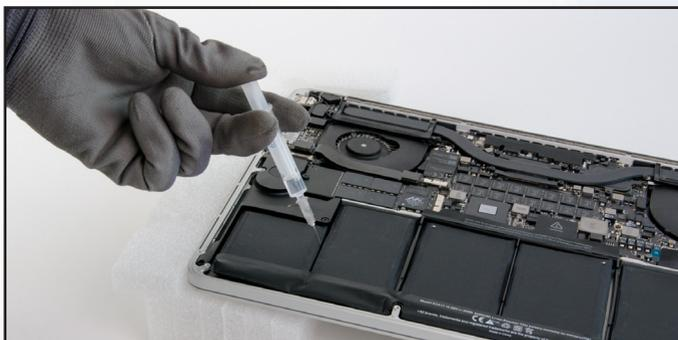
**Wichtig:** Warten Sie 2-3 Min. nach dem Auftragen des Lösungsmittels, bevor Sie mit dem Keil die Batterie anheben!
