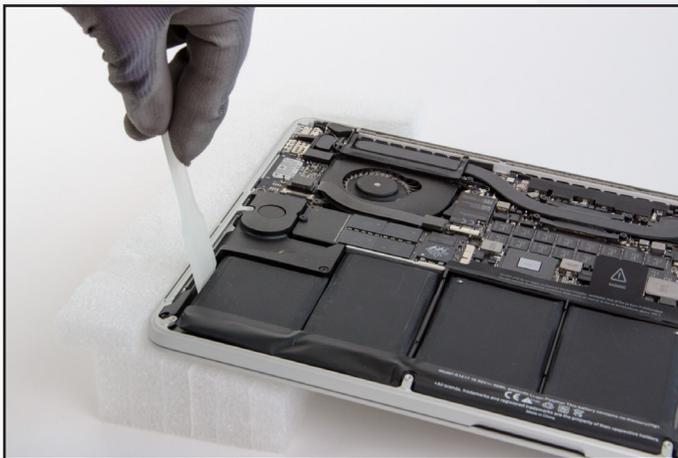
Benutzen Sie die restlichen 0.5 ml des Lösungsmittels, um die zweite Zelle zu entfernen (analoges Vorgehen).
