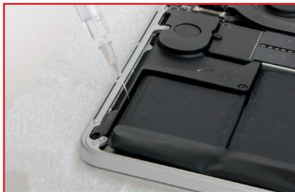
**Wichtig:** Warten Sie 2-3 Min. nach dem Auftragen des Lösungsmittels, bevor Sie mit dem Keil die Batterie anheben!
