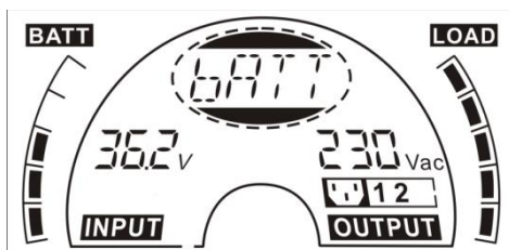
■ Режим работы от батарей
